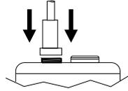
Asegurese de que el manguito está correctamente insertado en la sonda, con los orificios hacia la parte superior de la sonda (la parte más cercana al cable).
