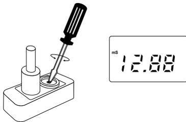
Nota: También es posible estandarizar la calibración para tener lecturas compensadas a 20°C (68°F) en vez de 25°C (77°F). Como se describe arriba, durante la calibración, simplemente ajuste el potenciómetro a la lectura de la solución de calibración a 20°C (68°F). Por ejemplo, para el HI 7030 / HI 8030 este valor es 11,67 mS/cm y puede encontrarse en la tabla de conductividad-temperatura en la página 22.
