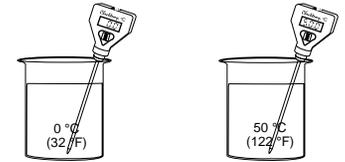
Nota: Tras la calibración de la temperatura, recalibre el instrumento (para contenidos de conductividad o fertilizante).
