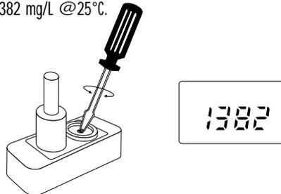
Nota: También es posible estandarizar la calibración para tener lecturas compensadas a 20°C (68°F) en vez de 25°C (77°F). Simplemente ajuste el potenciómetro a la lectura de la solución de calibración a 20°C (68°F). Por ejemplo, para el HI 7032 este valor es 1.251 mg/L y puede encontrarse en la tabla de TDS-temperatura en la página 23.
