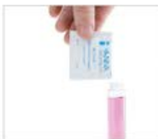
Agregue el reactivo a la muestra de agua
