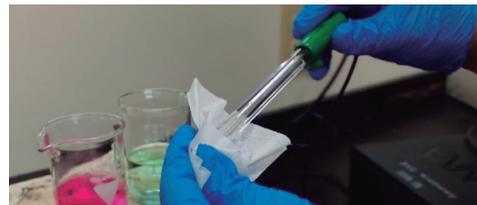
Un electrodo **seco** conduce a desviaciones en la medida de pH, tiempos de respuesta lentos y mediciones incorrectas.
