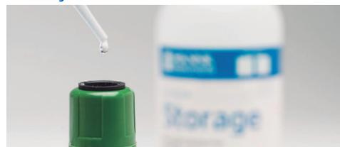
**Revive** un electrodo seco sumergiendo la membrana y la unión en solución de almacenamiento de pH (HI70300) durante al menos una hora.
